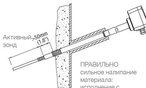
ПРАВИЛЬНО длинный штуцерный ввод: исполнение с пассивным удлинением
